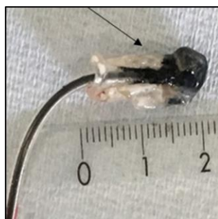
Photographie de la pile à combustible après 5 mois d'implantation. La flèche désigne un très faible niveau de bio-encrassement.
